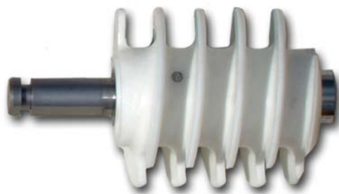
Ebenfalls patentiert: Die Mischschnecke.
